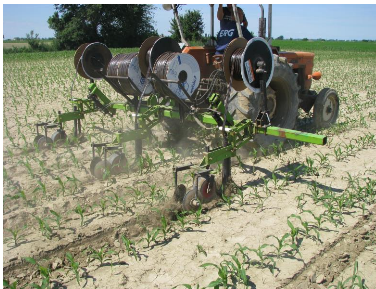
Figura 1. Posizionamento dell'ala gocciolante tra i filari di mais
