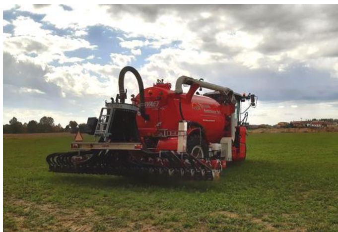
Figura 2. macchina che interra il liquame con dischiera in funzione
